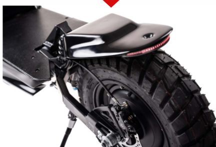
Zadní kolo s integrovaným motorem
